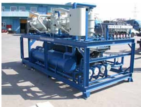
Установка ледяной воды на отгрузочной площадке
