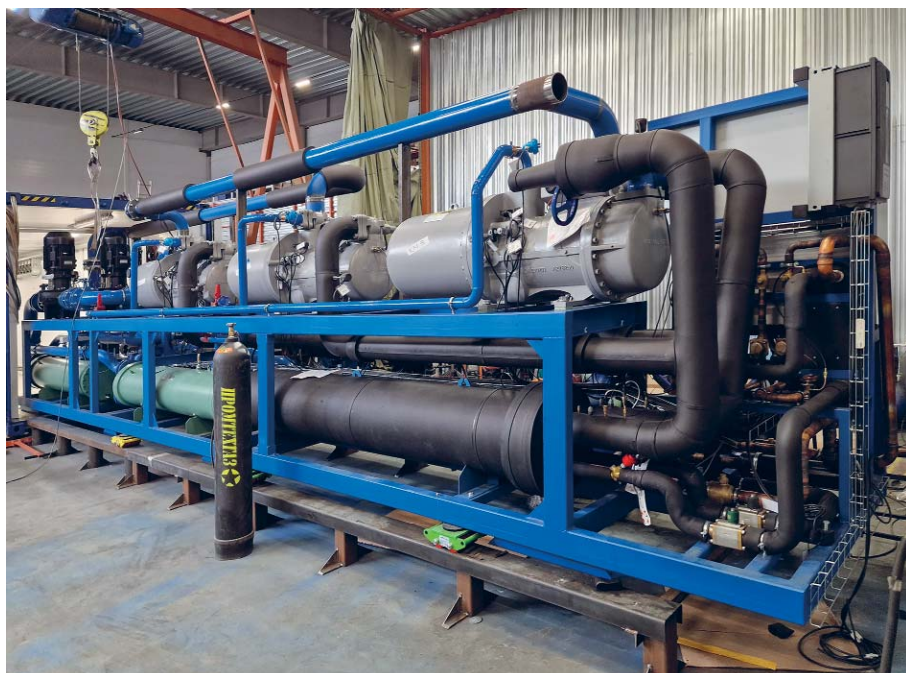
Изготовление холодильной машины на производственном участке
