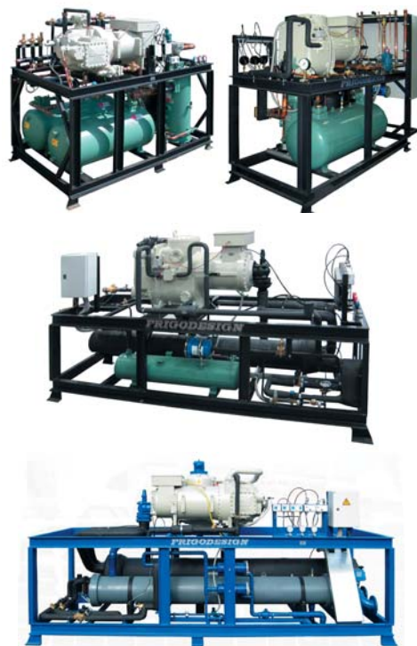
Рис.2. Конструкторские решения при производстве холодильных агрегатов и чиллеров на компрессорах J&E Hall
