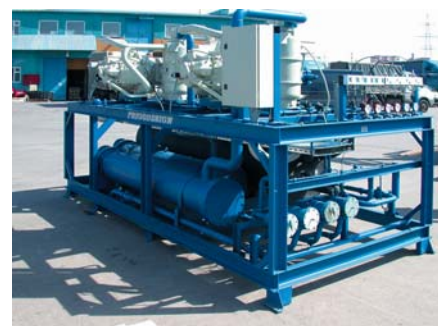
Установка ледяной воды ( 1...2^{\circ}\text{C} ) для молокозавода, г.Каменск-Уральский
