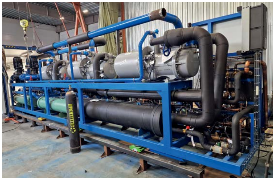
Собранная холодильная машина перед установкой её в контейнер
