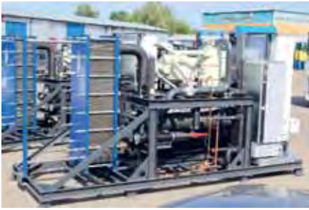
Генераторы ледяной воды с расходом 87,5 м 3 /ч перед отгрузкой заказчику
